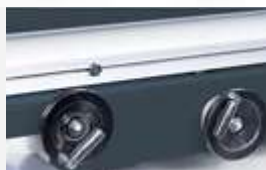
Pokrętła przesuwu ręcznego stołu z podziałkami, blokadą oraz zabezpieczeniem dla bezpiecznej i ułatwionej obsługi (od 1020 wzwyż)
